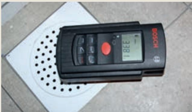
Figur 2: Elektroniske lengdemålere registrerer lengder og beregner høydeforskjeller
