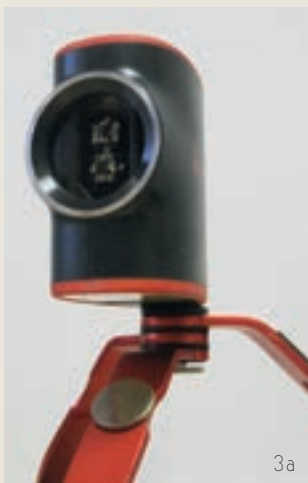
Figur 2: Elektroniske lengdemålere registrerer lengder og beregner høydeforskjeller
